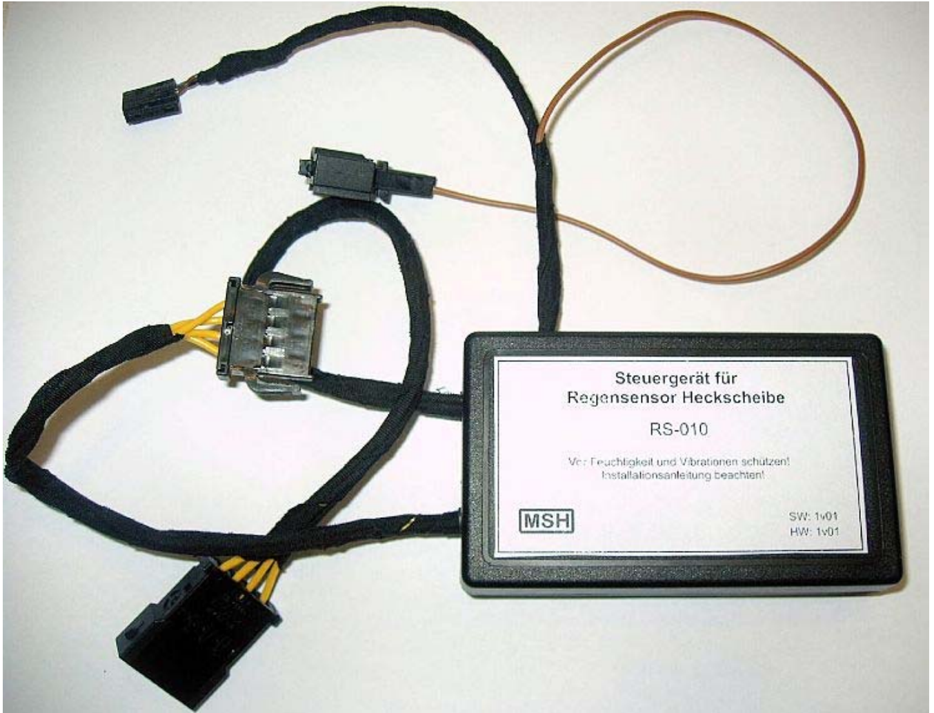
Bild 20: Fertig endmontiertes Steuergerät
